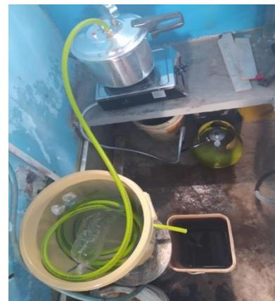
Gambar 1. Rangkaian alat distilasi asap cair
