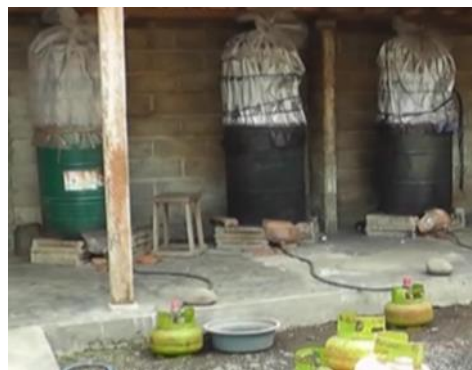
Gambar 1 . Drum Bekas Oli untuk Sterilisasi Baglog
