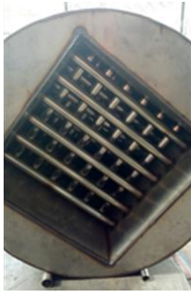
Gambar 5 . Boiler Sistim Pipa Api dan Lemari Sterilisasi Baglog
