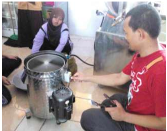
Gambar 4. Tim pelaksana pengabdian memperagakan penggunaan spiner untuk penirisan minyak setelah proses penggorengan vakum.
