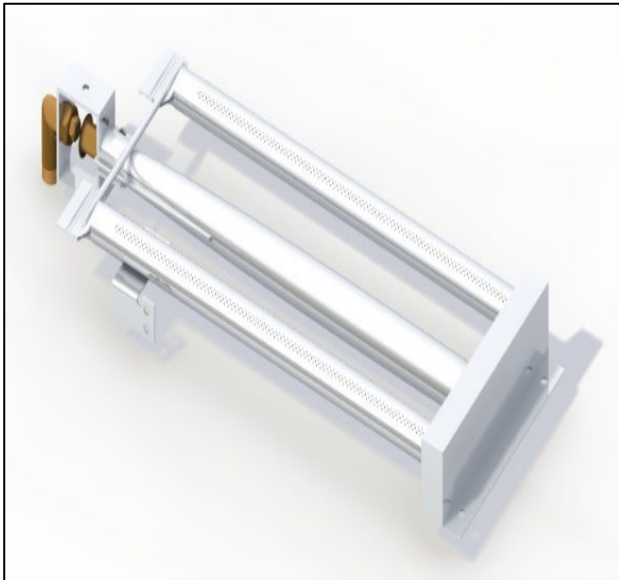
Gambar 2. Desain premix gas flame burner dengan multi nosse
