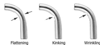
Gambar 4. Jenis – jenis kerusakan radius pipa
