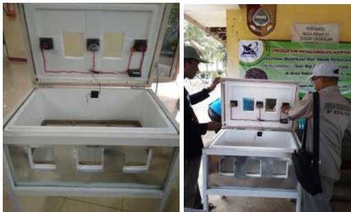
Gambar 2. Alat Perkecambahan (Germinator Elektrik) yang sudah dirakit
