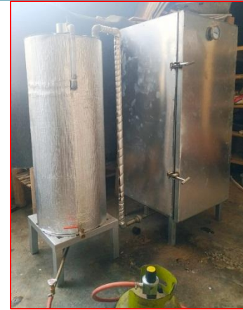
Gambar. Alat sterilisasi media baglog sistem uap air
