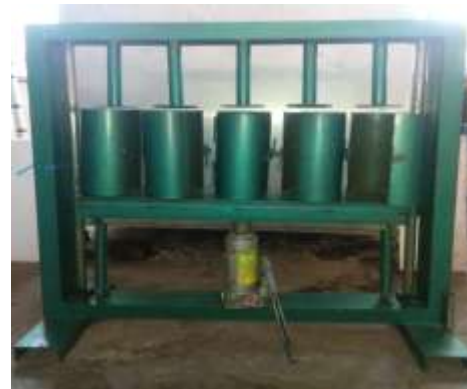
Gambar 1. Desain alat pemadat media/baglog sistem hidrolik
