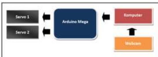
Gambar 1. Blok diagram prinsip kerja sistem
