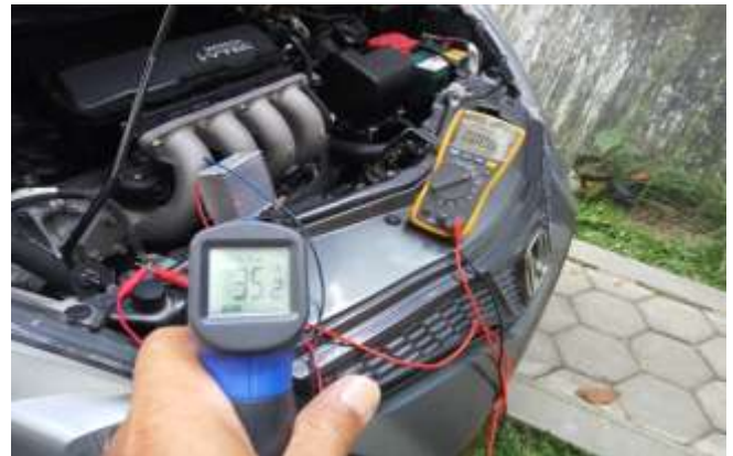
Gambar 4. Pengambilan data suhu dan tegangan elemen peltier
