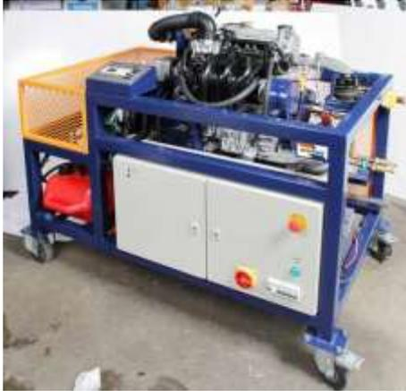
Gambar. 1 Alat Praktikum Motor Bakar yang digunakan di Prodi Otomotif POLIJE.
