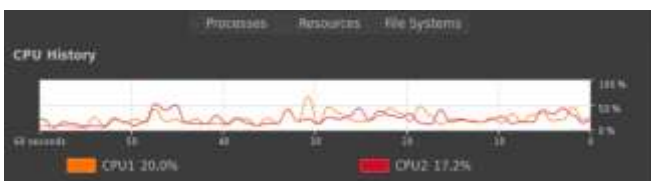
Gambar 10 Grafik CPU Usage setelah menggunakan IPTables ketika terjadi serangan DoS
