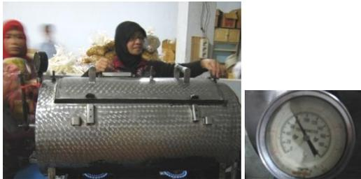
Gambar 3.1 Pemanasan alat *vacumm frying* hingga tercapai suhu 80-90 °C pada tekanan 70-78 cmHg
