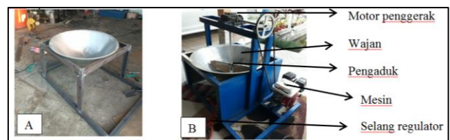
Gambar 2. Proses produksi mesin gula jahe (A. wajan, B. hasil akhir mesin produksi gula jahe)
