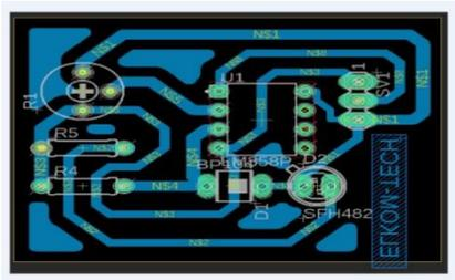
Gambar 2. Hasil desain PCB rangkaian elektronika sensor IR
