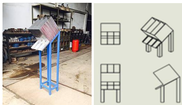
Gambar 2. Fabrikasi rangka, badan, dan wadah dari alat pengumpan otomatis
