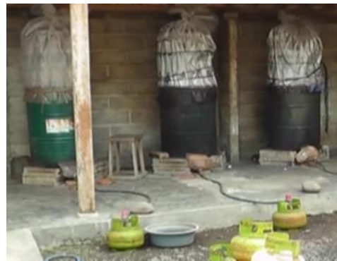
Gambar 1 . Drum Bekas Oli untuk Sterilisasi Baglog
