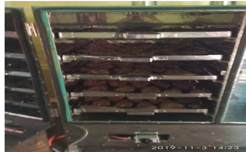
Gambar 3. Teknologi pengeringan ikan lele dengan menggunakan oven
