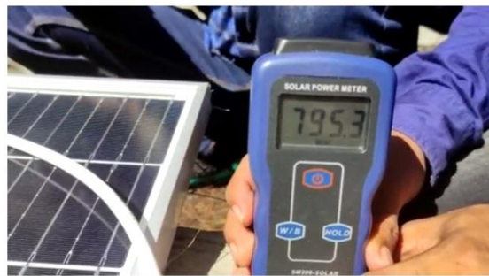
Gambar 3. Pengukuran intensitas cahaya
