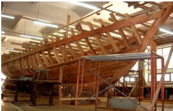
Gambar 6. Proses pembangunan kapal kayu secara modern
