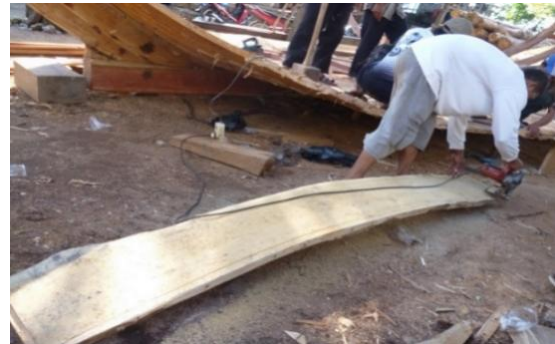
Gambar 4. Proses pembangunan kapal kayu tradisional
