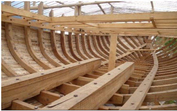
Gambar 9. Proses penyambungan pada lunas
