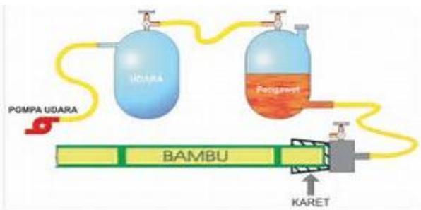
Gambar 10. Skema proses perlakuan pendahuluan bambu
