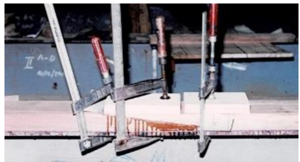
Gambar 6. Proses fitting, menyatukan bagian satu dengan lainnya
