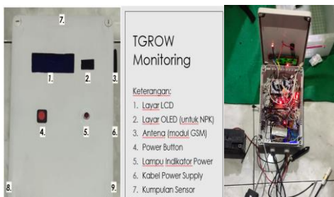
Gambar 2. Realisasi produk t-grow untuk monitoring tanaman jeruk.
