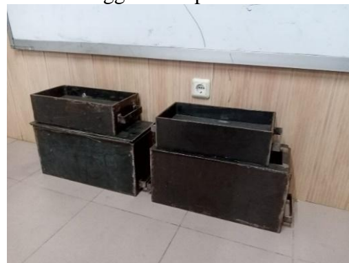
Gambar 4: Cetakan paving block
