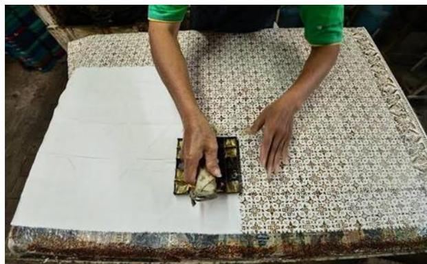
Gambar 1. Proses Pembatik Menggunakan Canting Cap
