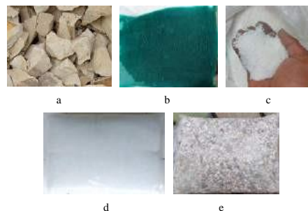
Gambar 5. Materi yang digunakan sebagai penyaring air, a. Batu zeolite, b. Arang aktif, c. Pasir silika, d. Dakron, dan e. Batu kali
