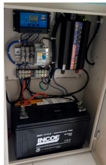
Gambar 8. Rangkaian Inverter, SCC dan Baterai
