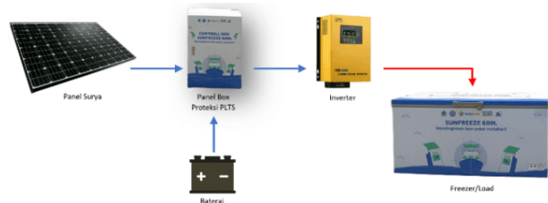
Gambar 6. Skema Teknologi Pendingin PLTS (Sugianto, 2024)
