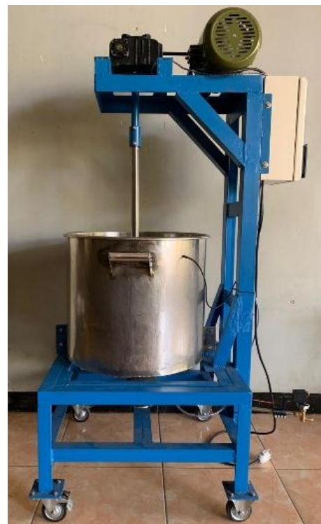
Gambar 8. Alat pembuat petis otomatis
