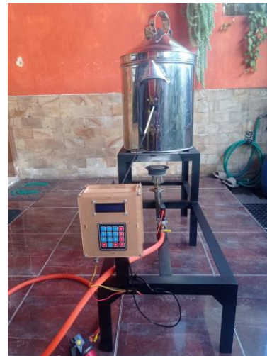
Gambar 7. Alat pengukus ikan otomatis dengan sumber energi gas elpiji
