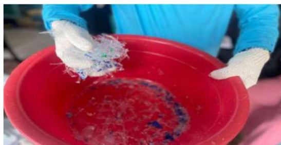
Gambar 3. Serpihan Plastik yang Keluar dari Mesin Pencacah
