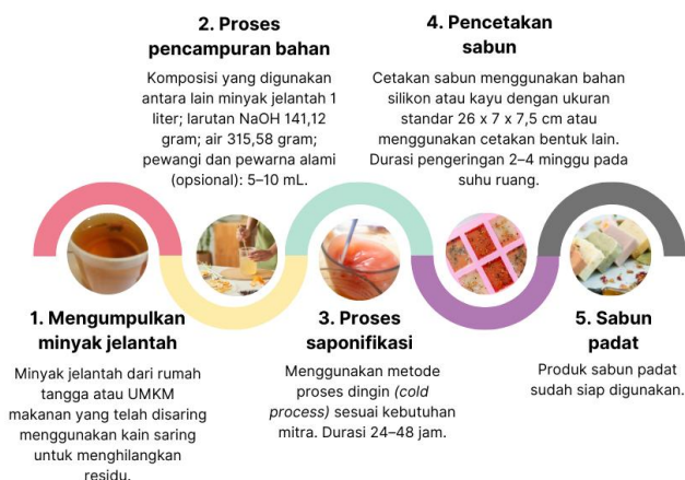
Gambar 1. Skema Pembuatan Sabun Padat Minyak Jelantah
