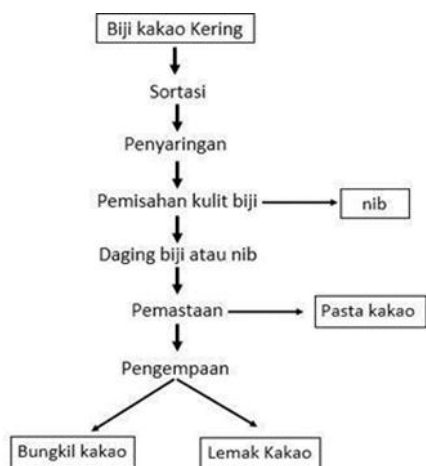
Gambar 1. Diagram Alir Proses Pengolahan Sekunder Biji Kakao
