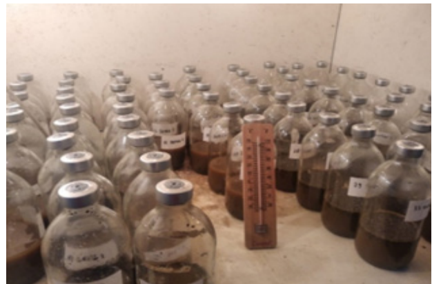
Gambar 1. Digester type batch yang digunakan pada penelitian ini
