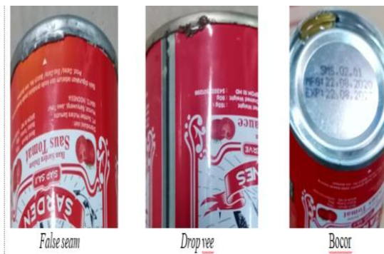
Gambar 2. Jenis defect false seam, drop vee, dan bocor
