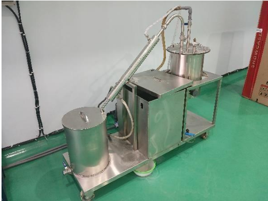
Gambar 1. Mesin distilator sederhana
