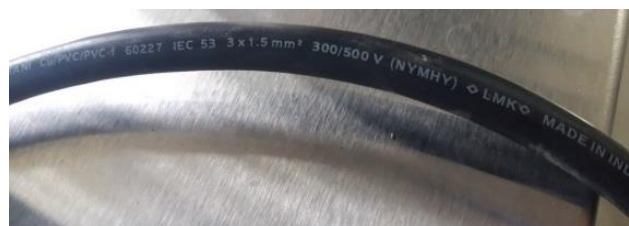
Gambar 9. Kabel Mesin Utama
