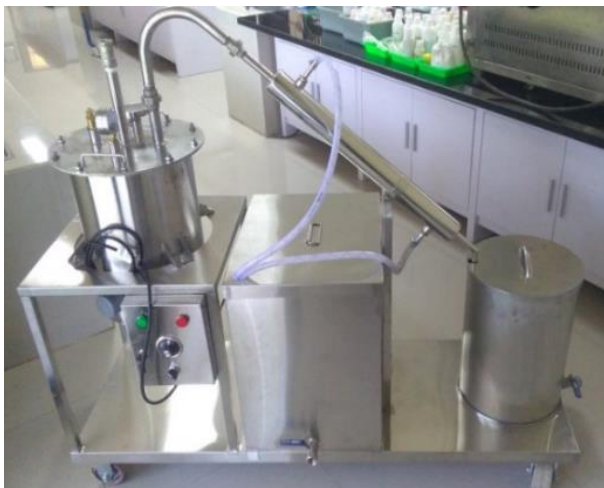
Gambar 1. Destilasi Sederhana PNPB 2020
