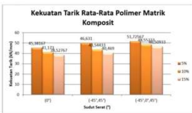
Gambar 2. Grafik Kekuatan Tarik Rata-Rata Polimer Matrik Komposit Berpenguat Serat Bambu Dengan Sudut Serat (0°), (-45°, 45°), Dan (-45°, 0°, 45°). Dengan Kadar Larutan Alkali 5%, 10%, Dan 15%
