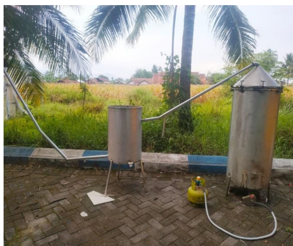
Gambar 1. Alat produksi asap cair grade 3
