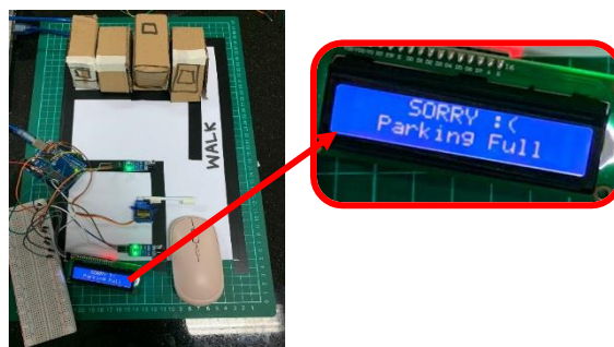
Gambar 17. Palang parkir otomatis dengan sensor IR Proximity
