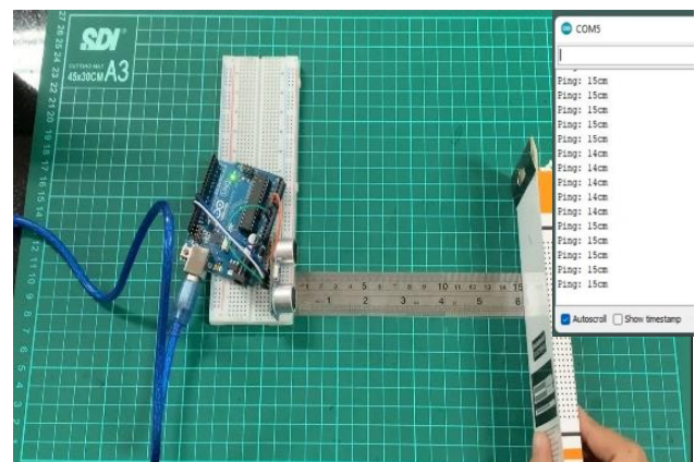
Gambar 30. Alat Ukur Jarak Menggunakan Sensor Ultrasonik
