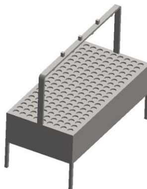
Gambar 3. Asumsi sederhana perangkat sistem pengkabutan pada box aeroponik
