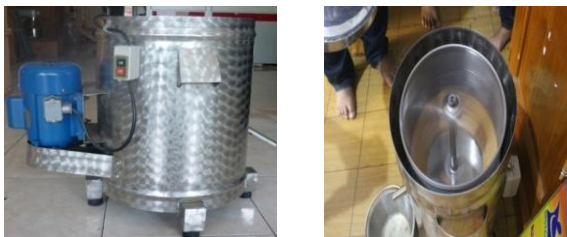
Gambar 1. Alat Peniris Metode sentrifugas dan pengoperasiannya
