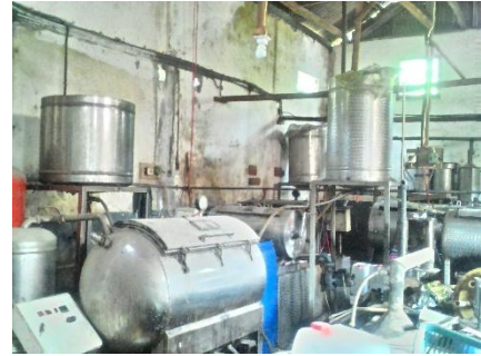
Gambar 6. Tabung penggoreng kapasitas 50 kg bahan baku
