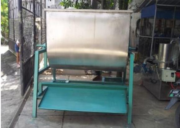
Gambar 2. Mesin Pencampur media jamur
