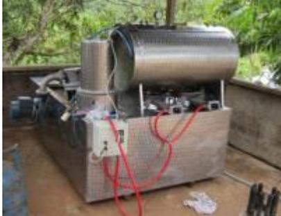
Gambar 1. Unit penggoreng vakum sistem *water jet*
