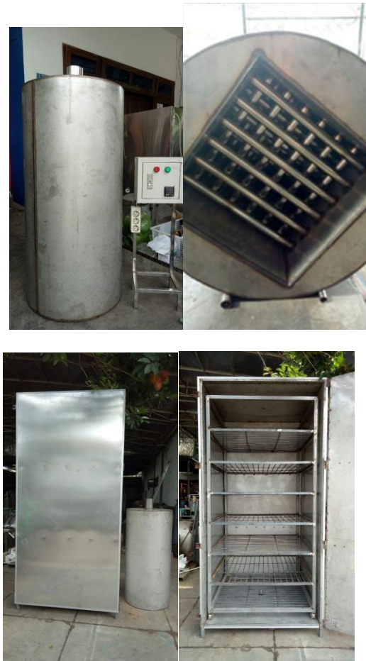
Gambar 5. Lemari Sterilisasi Baglog dengan Boiler Sistim Pipa Api
