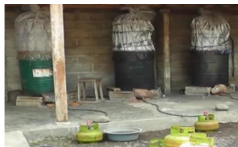
Gambar 1. Sterilisasi Baglog dengan Drum Bekas Oli
